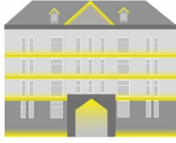
屋顶轮廓照明 局部重点照明
